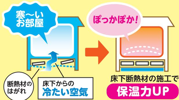
Aclear アクリア 使用する断熱材は、旭ファイバーグラス製グラスウール「アクリア」を使用しています。
